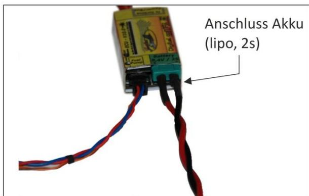
Dadurch ist es jetzt auch möglich die ECU ohne Empfängerstromversorgung zu betreiben. Eine automatische Abschaltung erfolgt nach 60 sec. Inaktivität. Durch gleichzeitiges drücken der Tasten „Manual & Run“ auf der GSU kann manuell abgeschaltet werden
